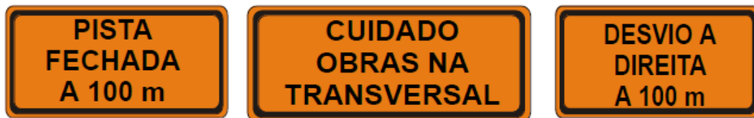
Figura 2 – Placas especiais de advertência de obra
