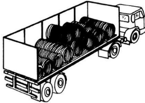
Figura 2 - Disposição durante o transporte dos tubos fornecidos em bobinas.
