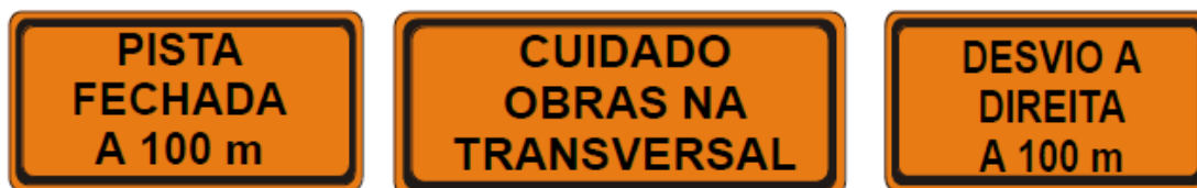
Figura 2 – Placas especiais de advertência de obra
